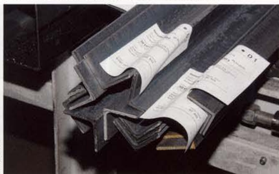
Das Zeichen „D1“ auf dem Bundetikett markiert den Bereitstellungspolder und erlaubt eine einfache Sichtkontrolle.
